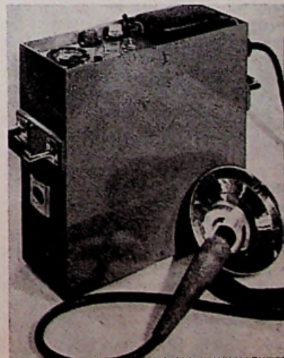
Fig. 5. De uitvoering van het hier beschreven flitsapparaat. De reflector met flitslamp is met een zes meter lange kabel aan apparaat bevestigd.
